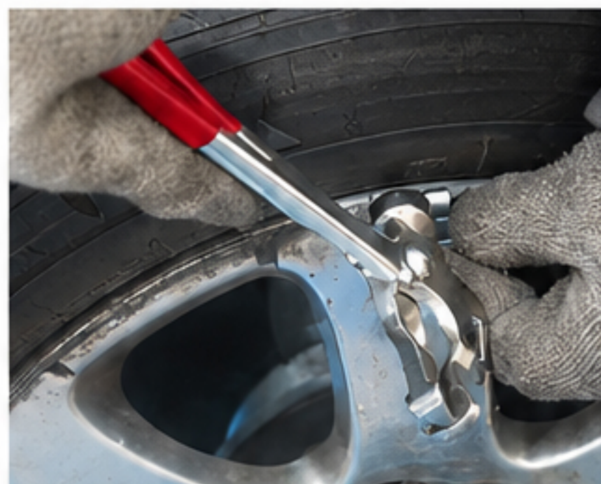
INSTALA Y AJUSTA CONTRAPESOS
